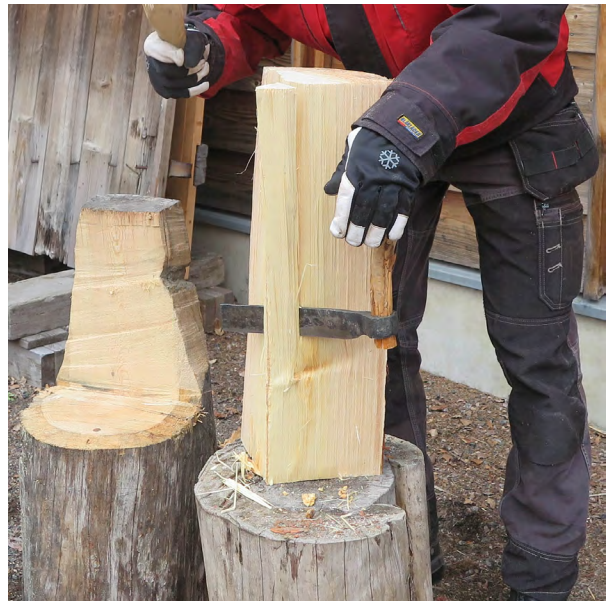
Kuva 16: Neljännesten halkaisun jälkeen pärepuusta poistetaan ydin.
