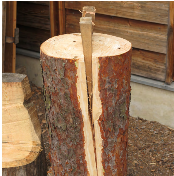
Kuva 14: Pärepuu halkaistaan ensin puukiilojen avulla puoliksi.
