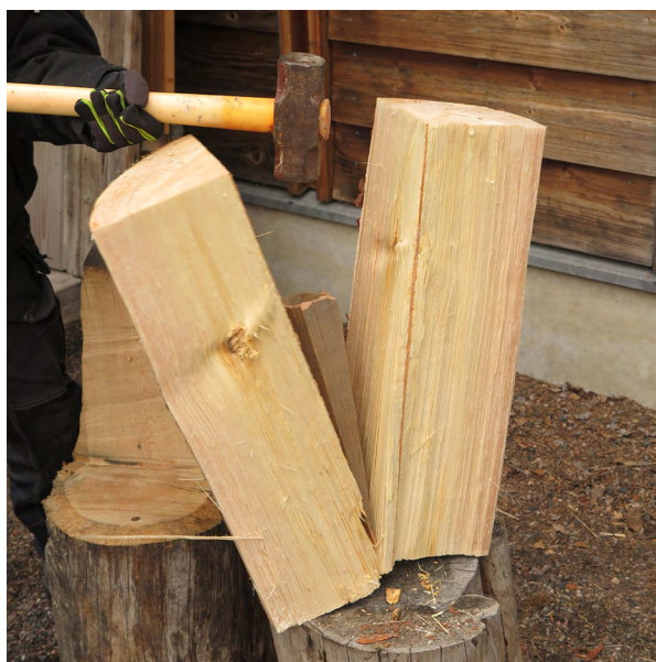
Kuva 15: Pärepuun puolikas halkaistaan neljäsosiksi.
